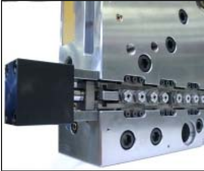
Hydromechanischer Nadelverschluss in der Detailansicht
